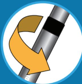
4 Vor dem Zerlegen des Gestänges alle Drehverschlüsse zur Gänze öffnen. Danach mit einem Zug die Stangen-Segmente voneinander trennen.
