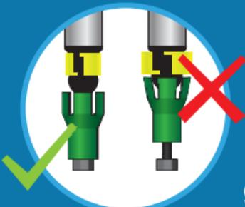
2 Stecke anschließend der Dicke nach aufsteigend das Gestänge ineinander. Dabei kann etwas Kraft aufgewendet werden.
